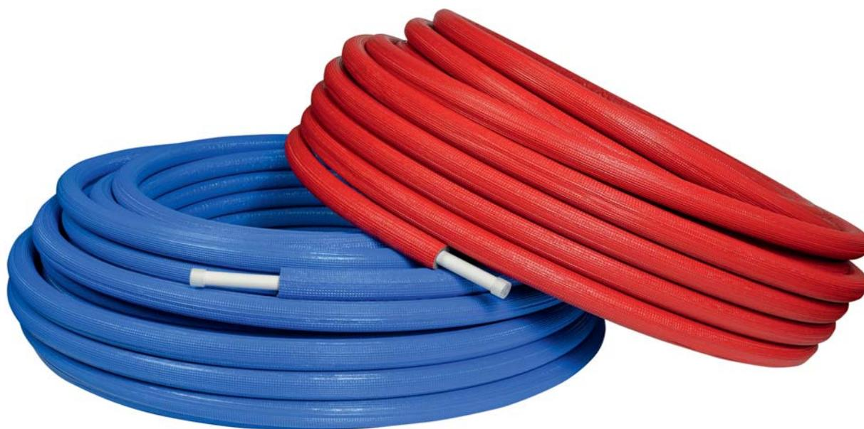
Металлополимерные трубы на основе термостойкого полиэтилена второго типа с внутренним слоем алюминия, на которые нанесена теплоизоляция из вспененного полиэтилена повышенной плотности с прочным защитным покрытием.
